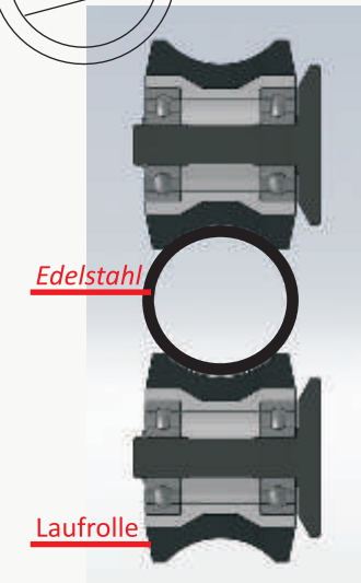
Querschnitt durch das Führungssystem: Geschliffene Führungen (Mitte) und elastisch beschichtete Laufrolle (oben/unten)
