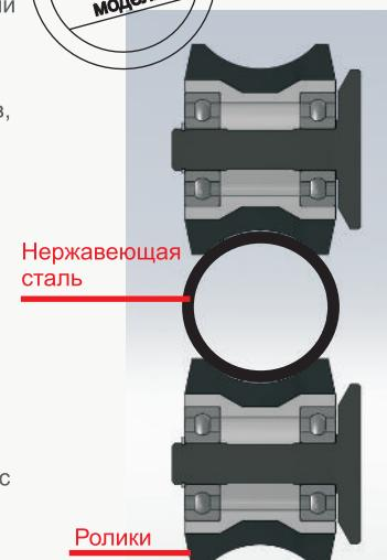
Разрез ведущей системы: в середине отшлифованная направляющая, сверху и снизу ролики с двойным эластичным покрытием.
