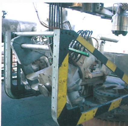
oben: roTeg-Hydraulikfahrzeug beim Öffnen einer Cokertrommel
