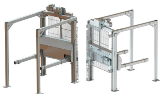
Das Palettenmagazin ist ausgelegt, um bis zu 15 Paletten im Stapel zu speichern. Aus dem Leerpallettenmagazin können Paletten vereinzelt und automatisch an die nachgeschaltete Fördertechnik zur Leerpallettenversorgung der Roboteranlage übergeben werden.
