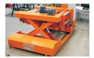
Der Palettenverfahrwagen ist für den Transport von Leer- und Vollpaletten innerhalb der Roboterzelle konzipiert.
