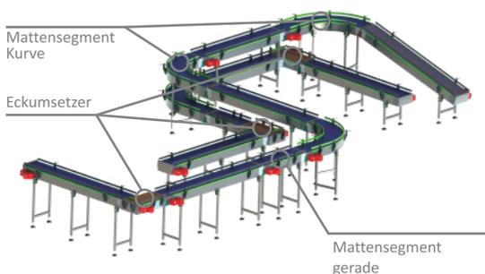
Die Fördertechnik wird als Mattensegment für den geradeaus-Transport der Packstücke verwendet.
