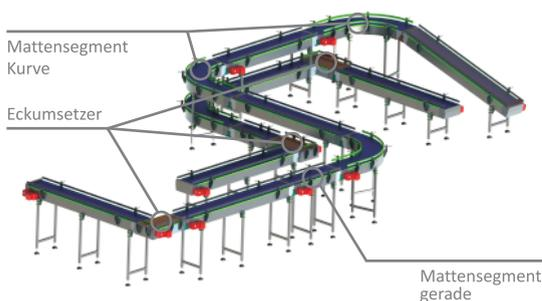
Die Fördertechnik wird als Mattensegment für den Kurven-Transport der Packstücke verwendet.
