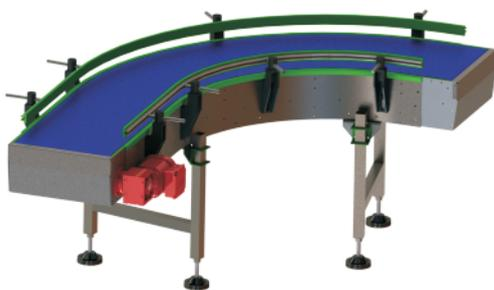
Die Fördertechnik für Packstücke übernimmt die Packstücke vor der Roboterzelle und führt diese einer Übergabestation in der Roboterzelle zu.
