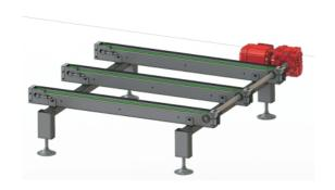
Die Palettenfördertechnik wird für den Quertransport von Paletten verwendet. Die Seitenführungen der angebotenen Palettenfördertechnik bestehen aus verzinktem Stahl, ebenso wie die niveauregulierbaren Standfüße.
