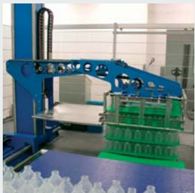
oben: Palettierrobotersystem PARO Mitte: Vakuum-Greifsystem unten: System zur lagenweisen Depalettierung von Flaschen
