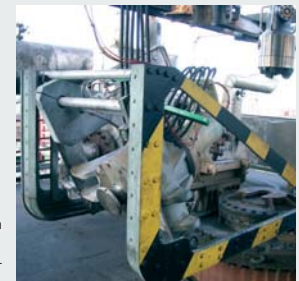
oben: roTeg-Hydrofahrzeug beim Öffnen einer Cokertrommel unten: Automatisches Verschlussystem für den Raffineriebereich
