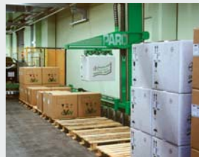
oben: Montage und Fertigung in Dortmund unten: Anlage mit 11 Plätzen zur Palettierung schwerer Packstücke (bis 70 kg)
