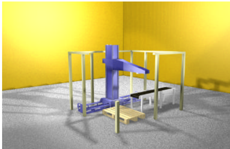
Roboterzelle PARO zur Palettierung und Depalettierung
