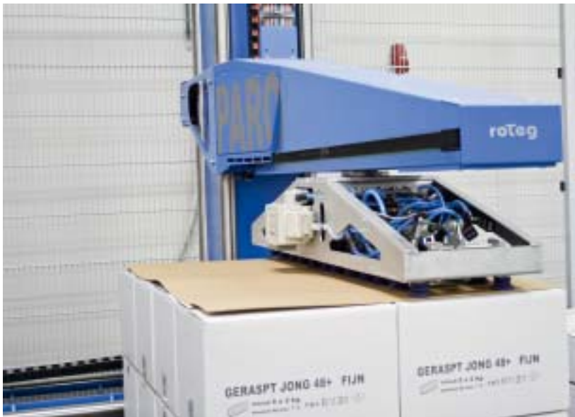
Das Auflegen von Zwischenlagen mithilfe von Vakuumsaugern gehört zu den Routineaufgaben von Paro-Palettierrobotern
