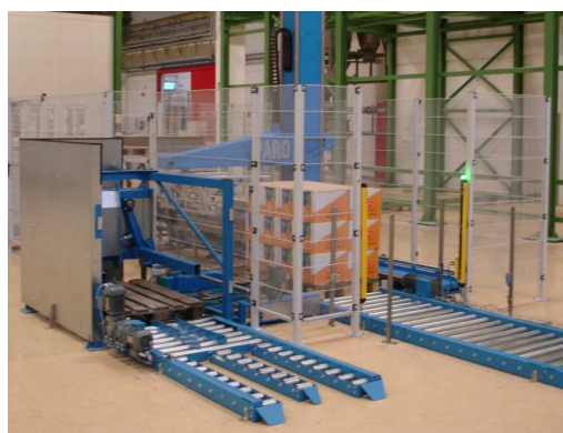
Palettierroboter PARO als vollautomatische und kompakte Palettierzelle
